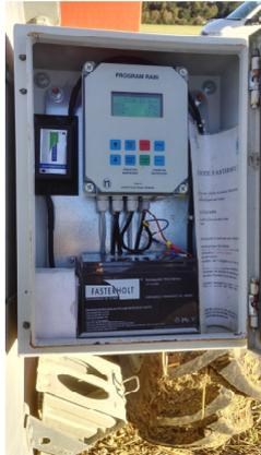
Photo 2 : La partie commande existante gérant les différentes recettes d'irrigation
