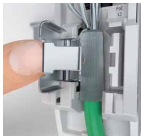
Pour le moment, il existe deux versions de la spécification PoE. Chaque PSE dispose au niveau de chaque port du réseau de 15,4 W maximum. Dans la pratique et pour un câble de 100 mètres de longueur, cette valeur n'est plus que de 12,95 W dans le PD. Le standard IEEE 802.3at (PoE+) a été développé pour alimenter les équipements terminaux nécessitant beaucoup d'énergie. Il livre 30 W.
